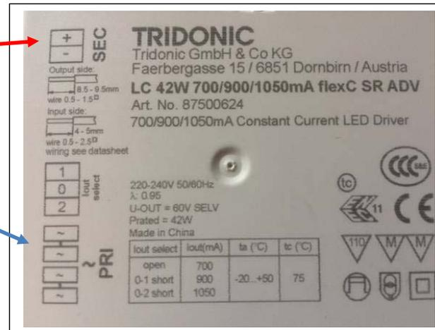
Le driver tridonic est en technologie « double isolation » qui ne nécessite aucun raccordement à la terre.
